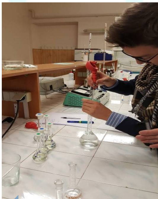
11 pav. Ruošiami tirpalai kalibracinei kreivei sudaryti. Į profesorius paruoštus Fe tirpalus atitinkamai pilamas etaloninis tirpalas
