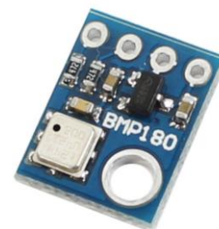
2.3.1 pav. BMP180 slėgio jutiklis [11]
